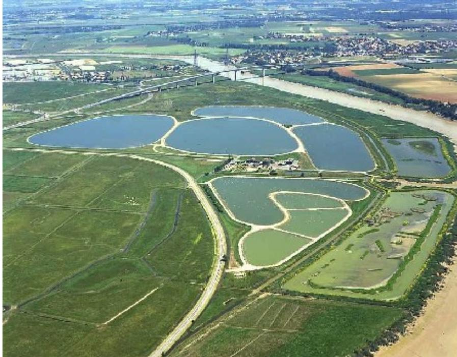
Une station de lagunage, c'est presque comme une station d'épuration. Le temps de séjour dans les 6 bassins, 4 mois, est suffisamment long pour permettre une élimination des bactéries, dont certaines mauvaises, par les rayons ultraviolets du soleil. Dans les lagunes, la vie se développe (daphnies et autres larves).
